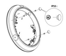
Afin de garantir l'étanchéité du luminaire l'utilisation des passes-fils est impérative.
