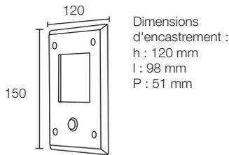
Fourni avec boîte métallique d'encastrement, possibilité de couler dans le béton ou de fixer par vissage.
