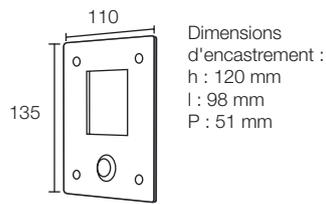
Fourni avec boîte métallique d'encastrement, possibilité de couler dans le béton ou de fixer par vissage.
